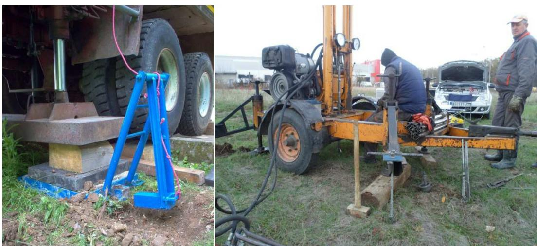
Slika 3.7. Poluautomatski (levo) i ručni čekić (desno)
