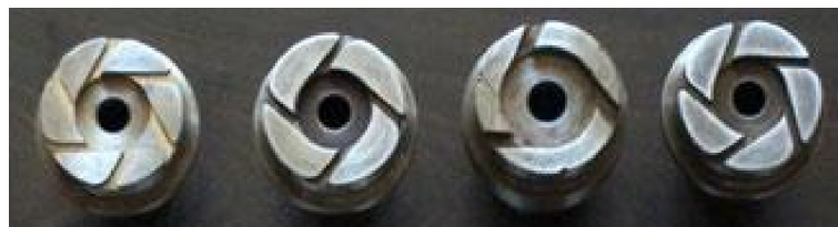
Слика 2.4: Изглед шест, четири, три и пет млазница, Mohanty and Ray (2012).
