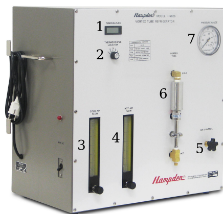
Слика 2.11: Расхладна/грејна јединица са вртложном цеви као извором топлог и хладног ваздуха: 1 - читавање вредности температуре, 2 - подешавање позиције термopара, 3 - мерење протока загрејаног ваздуха, 4 - мерење протока охлађеног гаса, 5 - подешавање жељеног протока, 6 - вртложна цев, 7 - мерење притиска; http://www.hampden.com/product-details.php?viewid=984
