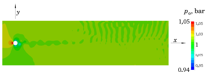
Слика 5.36: Расподела тоталног притиска, sonicTEFoam, k - \varepsilon модел.
