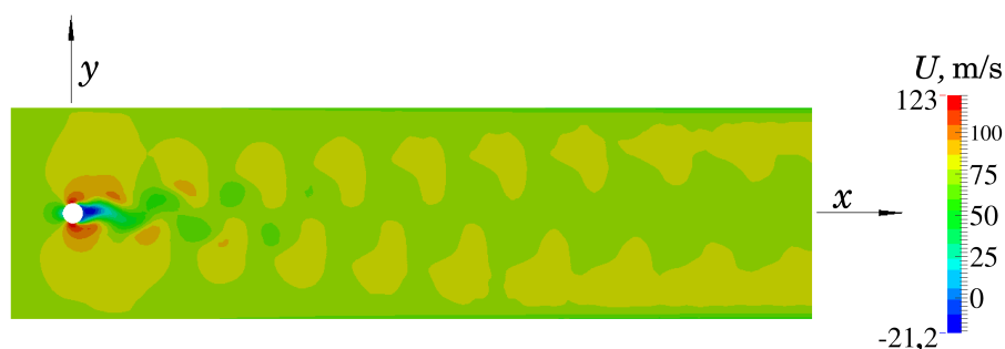
Слика 5.32: Расподела брзине у подужном правцу, sonicTEFoam, k - \varepsilon модел.
