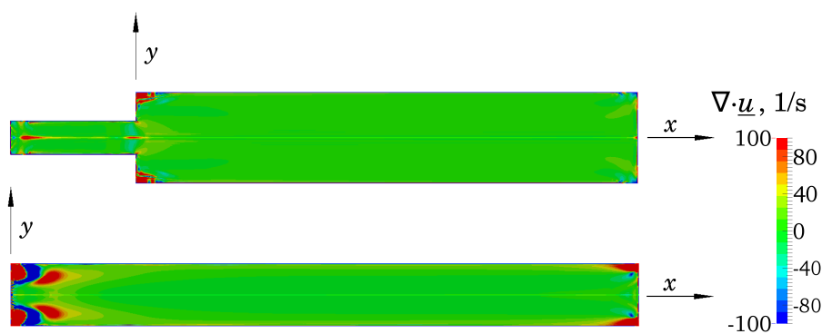
Слика 5.68: Дивергенција поља брзине у меридијанској равни вртложних цеви (А) и (Б).
