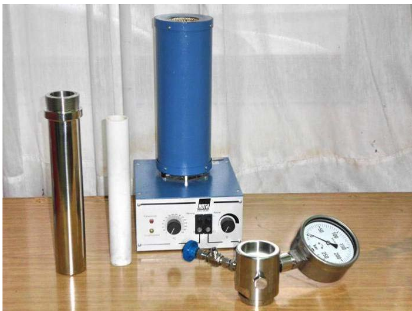
Slika 2.1. Autoklav proizvođača Carl Roth (Model II), korišćen za izvođenje hidrotermalne sinteze.
