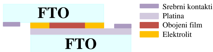
Slika 2.4. Poprečni presek sklopljene ćelije.
