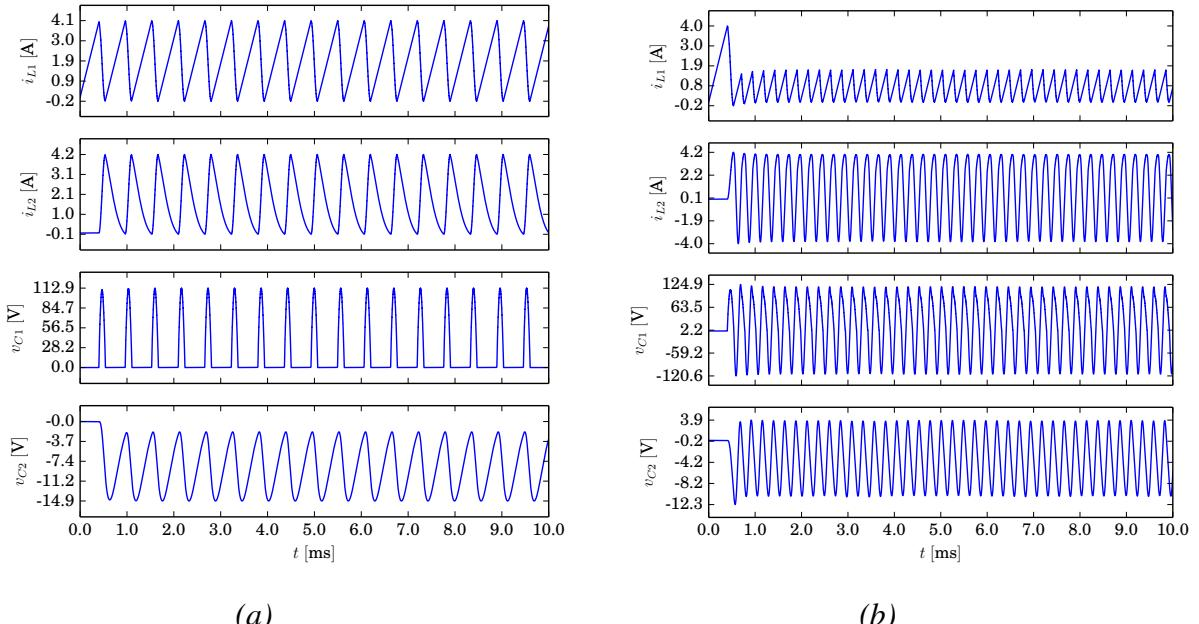
Slika 3.10: Vremenski dijagrami promenljivih stanja Ćuk konvertora za slučaj prekidačke površine  $S(\mathbf{x}) = x_1 + x_2 - 4$  kada su prekidači realizovani kao: (a) tranzistor i dioda i (b) strujno i naponski bidirekcionici.
