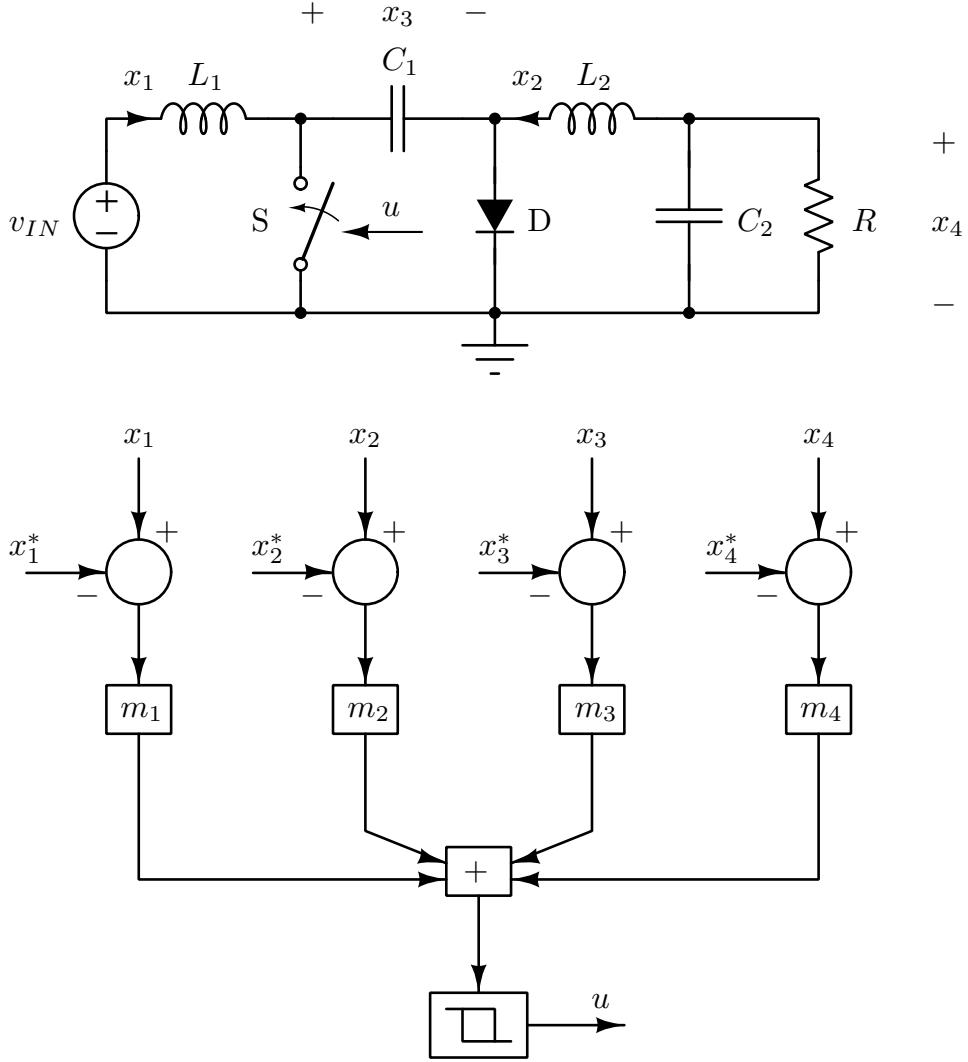
Slika 3.4: Ćuk konvertor (slika gore) sa histerezisnim sliding mode kontrolerom (slika dole).
