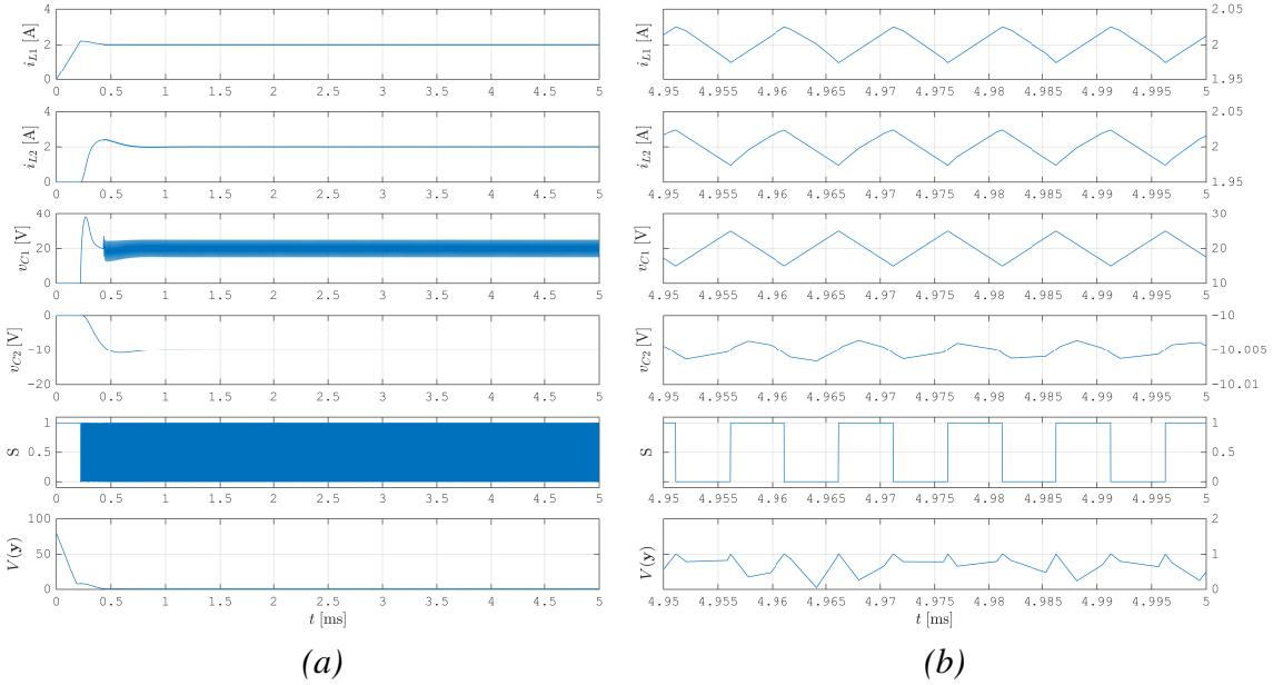
Slika 5.7: Vremenski dijagrami promenljivih stanja Čuk konvertora kada se upravlja strurom kalema  $x_1$  i naponom kondenzatora  $x_4$  za  $k_1 = 40 \text{ A}^{-1}$  i  $k_4 = -0.8 \text{ V}^{-1}$ : (a) u toku prvih 5 ms i (b) u intervalu vremena 4.95 ms – 5 ms.
