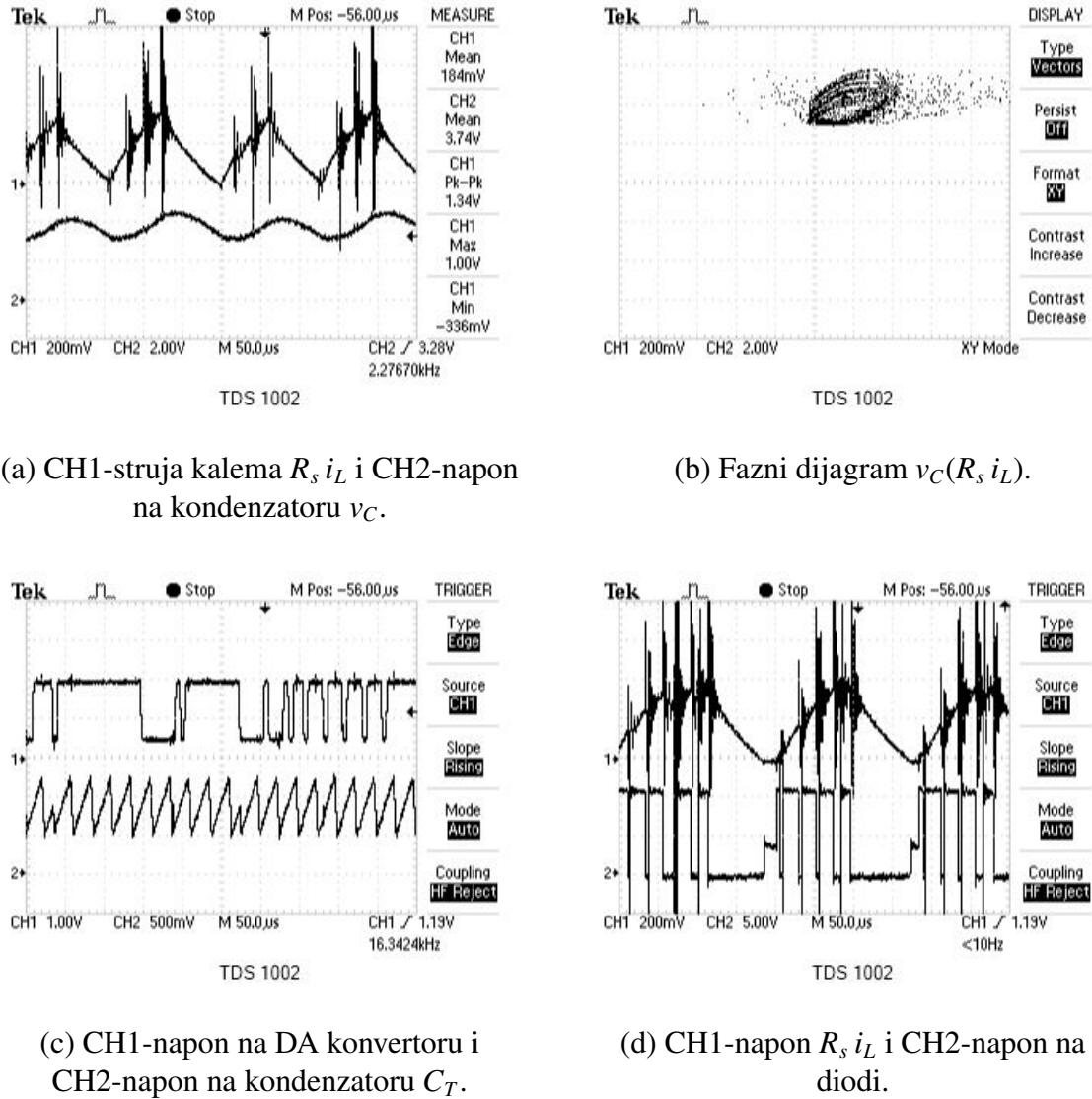
Slika 6.10: *Eksperimentalno dobijeni vremenski dijagrami sliding mode kontrolisanog buck konvertora sa primjenjenom prekidačkom površinom  $S(x) = x_2 - m_3$ , gde je  $m_3 = 3.5625$  V. Ulazni napon je  $v_{IN} = 12$  V, kondenzator  $C_T = 820$  pF i izlazna otpornost  $R = 10 \Omega$ .*
