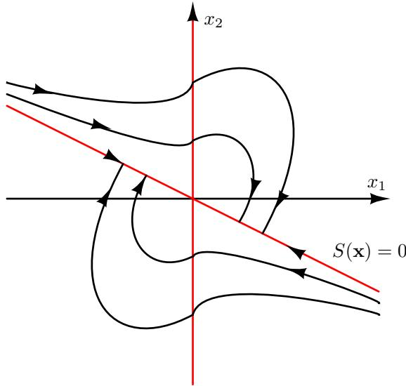
Slika 3.3: Fazni dijagram sistema sa sliding mode kontrolom.
