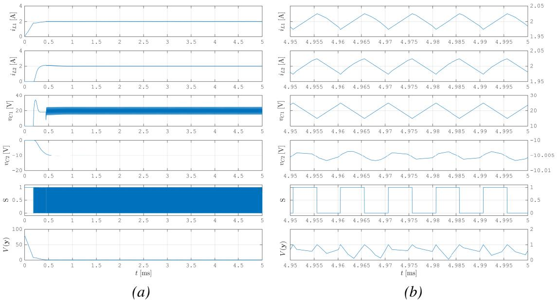
Slika 5.8: Vremenski dijagrami promenljivih stanja Čuk konvertora kada se upravlja strurom kalema  $x_1$  i naponom kondenzatora  $x_4$  za  $k_1 = 40 \text{ A}^{-1}$  i  $k_4 = 0.8 \text{ V}^{-1}$ : (a) u toku prvih 5 ms i (b) u intervalu vremena 4.95 ms – 5 ms.
