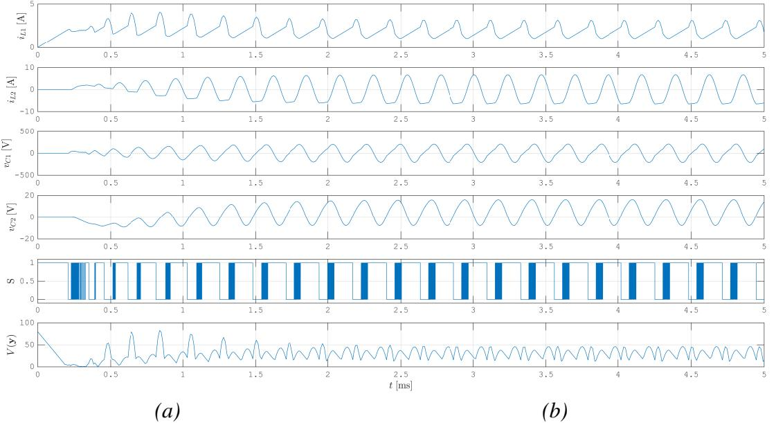
Slika 5.4: Vremenski dijagrami promenljivih stanja Čuk konvertora kada se upravlja strujom kalema  $x_1$  i naponom kondenzatora  $x_3$  za  $k_1 = 40 \text{ A}^{-1}$  i  $k_3 = 0.2 \text{ V}^{-1}$ : (a) u toku prvih 5 ms i (b) u intervalu vremena 4.95 ms – 5 ms.
