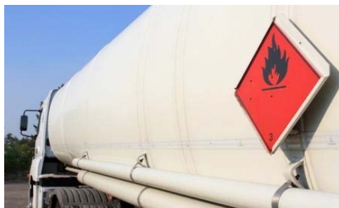
Слика 6. Постављање листице опасности на возило за превоз опасних материја
