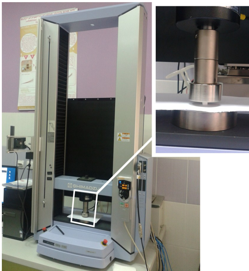
Slika 58. Šimadsu, univerzalna mašina za testiranje, pomoću koje su određene mehaničke karakteristike skafolda i prikaz testiranja.
