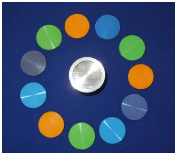
Slika 6.8. Otpisi ispitivanih otisnih materijala dobijeni iz modle po ISO 4823
