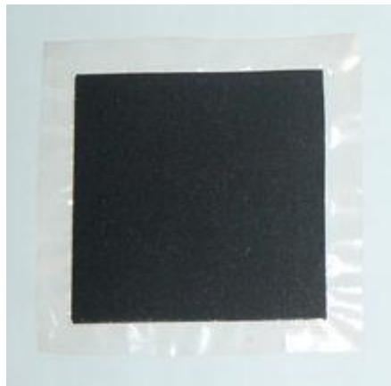
Slika 19. Izgled membransko-elektrodnog sklopa, MEA
