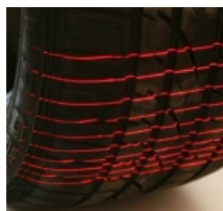
b) Uređaj za merenje dubine šare protektora autobusa „Pneuscan PRO“
