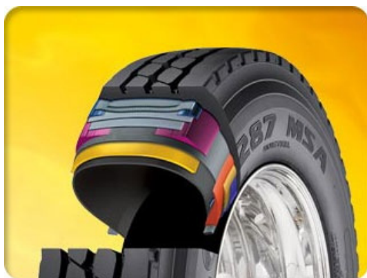
Slika 32. Presek pneumatika sa zaptivnim slojem
