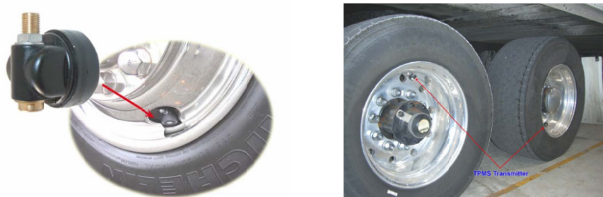
Slika 22. „Flow –Thru“ senzori za spoljnu montažu [15]
