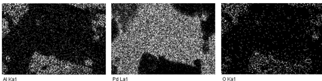
Slika 4.1.21: Površine radne Pd elektrode snimljena nakon 45 minuta katodne prenapetosti \eta = -0,015 V vs. Al nametnute jediničnim potenciostatskim pulsom sa početnog potencijala E = 1,000 V vs. Al; T = 250^\circ\text{C} .
