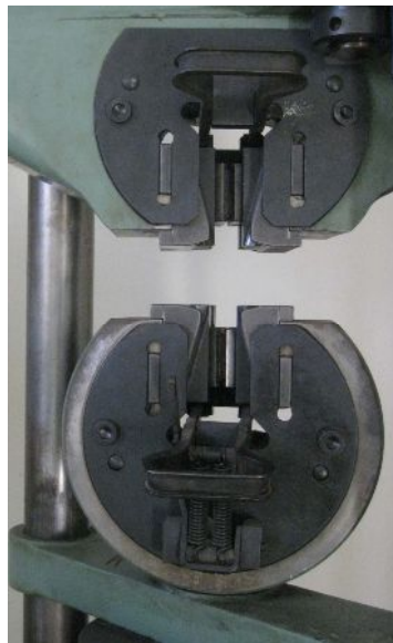
Слика 23 Чeљyст кидалице марке MFL-Pruf-und Mebsysteme GmbH, model D-6800 Mannheim
