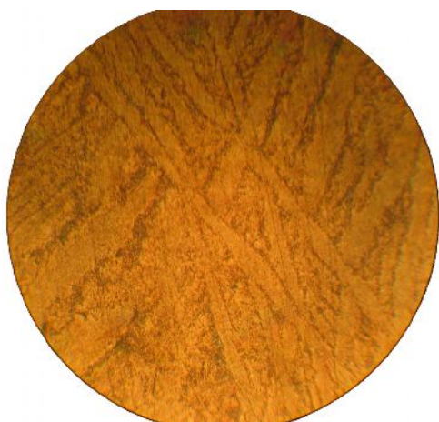
Слика 34 Микроструктура легуре SnZn12Bi8 (оптичка микроскопија)
