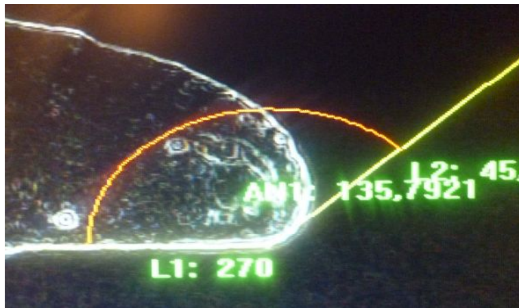
Слика 81 Аналитичко одређивање угла квашења легуре SnZn10Sb10 и бакарног субстрата на температури од 100°C изнад температуре ликвидуса
