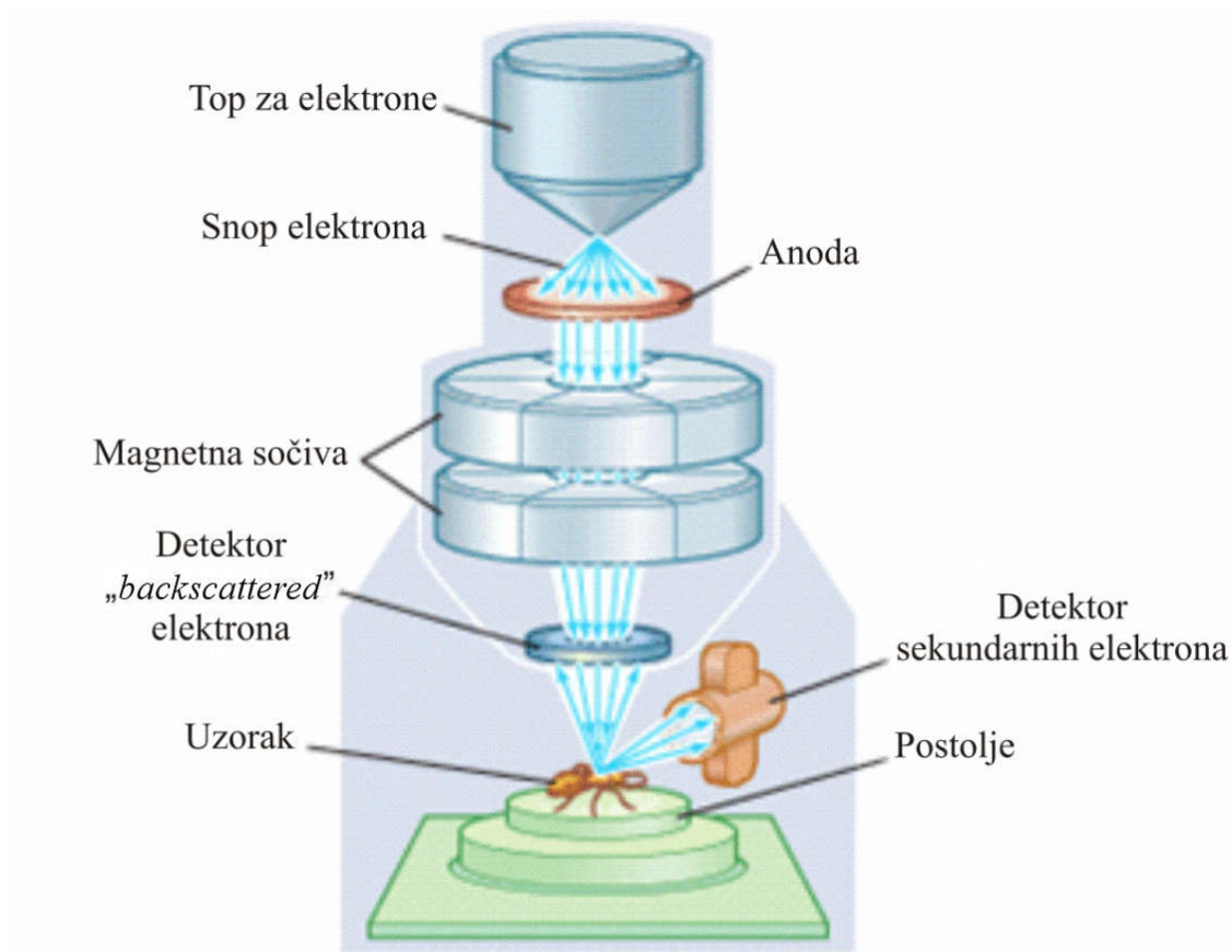
Slika 13. Šematski prikaz SEM-a (Đorđević, 2012)
