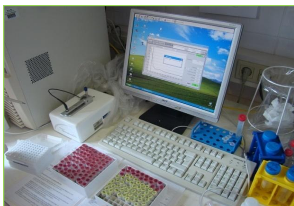
Слика 10. Провера концентрације и квалитета ДНК на спектрофотометру
