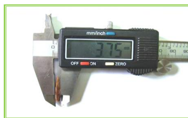
Слика 5. Мерење ширине пупољка дигиталним нонијусом
