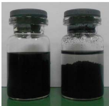
Slika 50. Rastvor MWCNT/PVB/etanol (levo) i MWCNT-etanol smeša sa istim sadržajem MWCNT (desno) [148]
