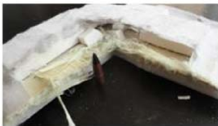
Slika 6. Struktura kompozita (na vrhu se nalaze keramičke pločice, potom sloj Twaron vlakana i na dnu je sloj polietilenskih vlakana) [45]
