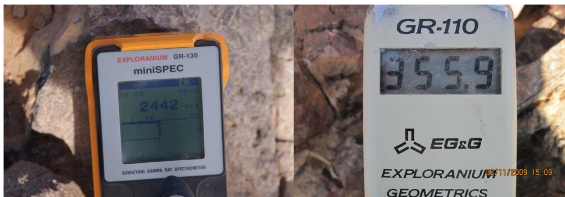
Slika 14. Izgled \gamma -spectrometra Exploranium GR-130-miniSpec (levo) i brojača GR-110 (desno) koji su korišćeni na terenu.
