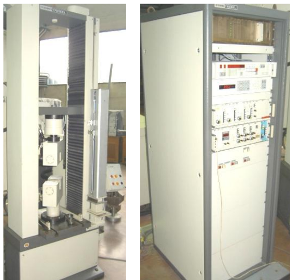
Slika 6.41. Univerzalna kidalica (100kN) i upravljačka jedinica Schenck Trebel
