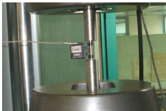
Slika 6.24. MTS ekstenzometar postavljen na epruvetu
