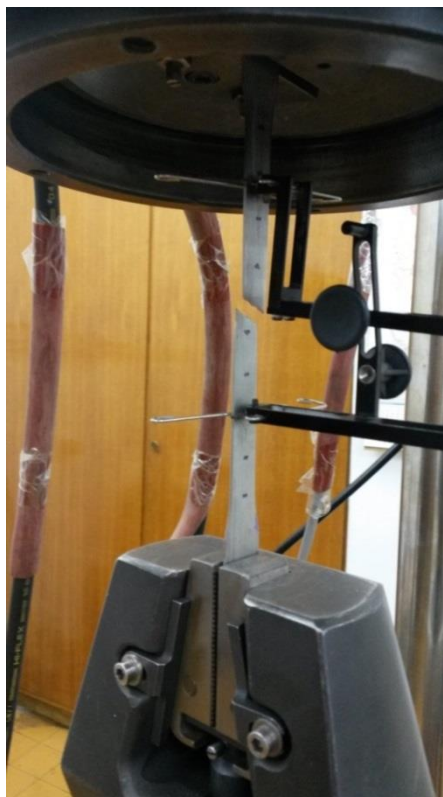
Slika 4.11. Ispitivanje zatezanjem na kidalici
