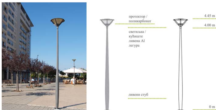
Слика 3.2.62 | Насеље „Белвил“, Инсталирана светиљка – изглед (лево); техничке карактеристике (десно)
