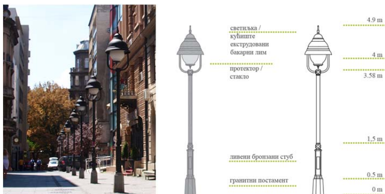
Слика 3.2.29 | Улица Николе Спасића, Инсталирана светиљка – изглед (лево); техничке карактеристике (десно)
