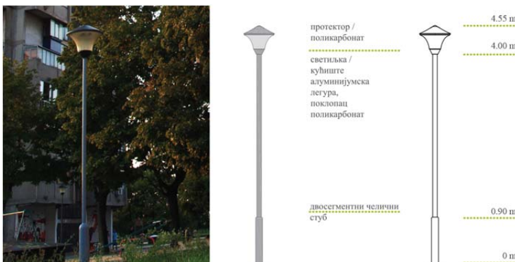
Слика 3.2.39 | Источна капија Београда, Инсталирана светиљка – изглед (лево); техничке карактеристике (десно)
