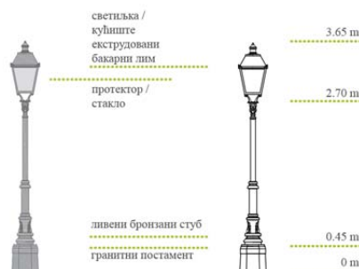
Слика 3.2.51 | Скадарска улица, Инсталирана светиљка – изглед (лево); техничке карактеристике (десно)
