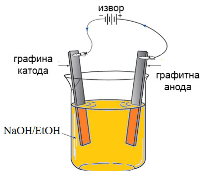
Слика 13. Апаратура за електрохемијску синтезу графитних квантних тачака
