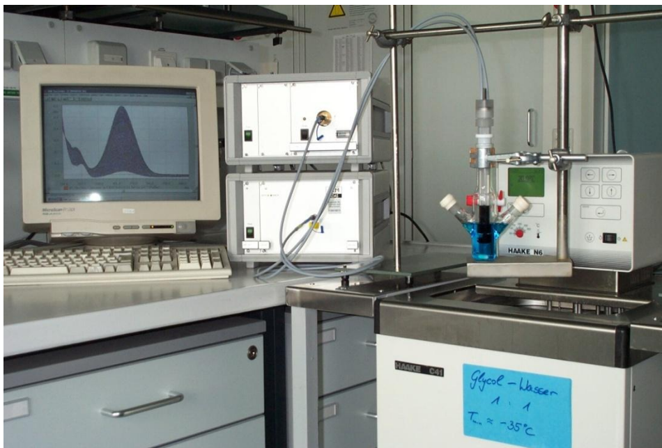
Slika 2.4 J&M TIDAS Diodenarray spektrometar sa kvarcnom sondom Hellma 661.502-QX
