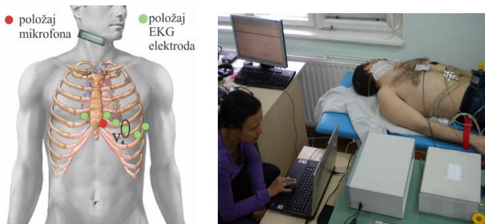
Slika 5.5. Postavljanje EKG elektroda, elektronskog stetoskopa i LPG senzora za snimanje karotidnog impulsa
