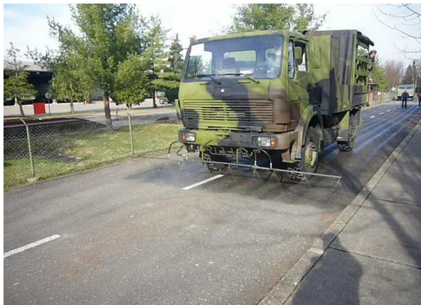
Слика 6.24. – Платформа за деконтаминацију на ТА ФАП 1118 БС/АВ, поглед са предње стране
