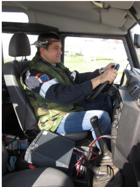
Слика 8.3.2.1. – Мерење буке у кабини возила
