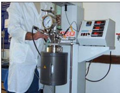
Slika 3.1. Parr -ov reaktor korišćen u eksperimentima hidrotermalnog procesiranja.
