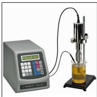
Slika 3.2. Ultrazvučni reaktor korišćen u eksperimentima sonohemijskog procesiranja. g
