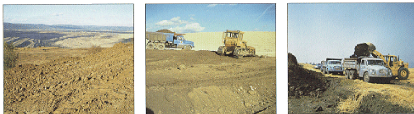
Слика 1.29. - Селективно откопавање и техничка рекултивација
