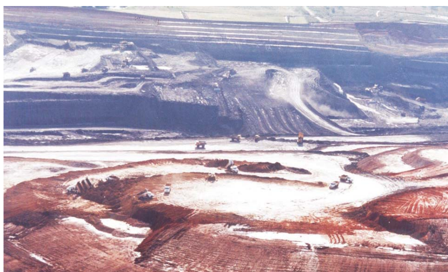
Слика 4.5 - Панорама површинског копа Recreio са дисконтинуалним радом услед претходног мињања средњих партија угља са правцем на предовања фронта радова, откопавањем откривке и њеног депоновања, односно одлагања на одлагалишту
