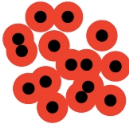
Slika 2.16. Šematski prikaz penetrirajućeg modela sa tvrdom ljuskom sa tvrdim česticama prikazanih crnom bojom i penetrirajuće ljuske prikazane crvenom bojom [161].
