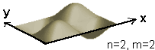
Slika 2.5 Modovi oscilovanja pravougaone membrane
