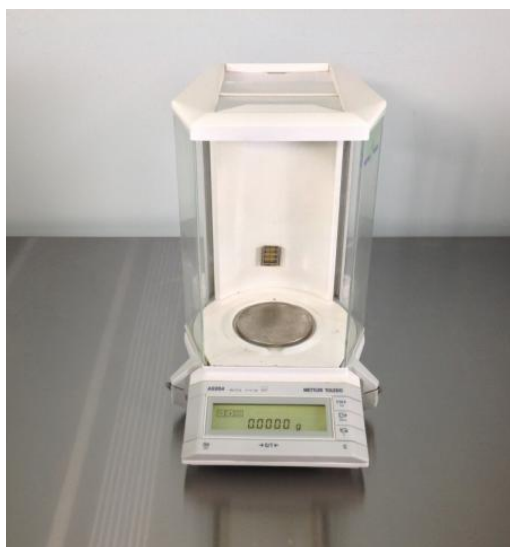
Slika 3.18 Analitička vaga Mettler Toledo AG204
