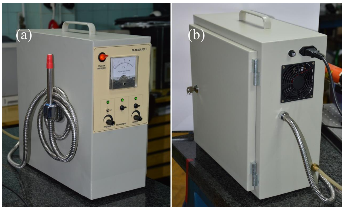
Слика 2.15: Плазмени млаз као компактан уређај са контролисаним напонем, фреквенцијом и протоком. (а) Изглед предње плоче уређаја и самог млаза плазме. (б) Задња плоча на којој су уводник за гас, напајање из градске мреже и извод плазменог млаза.
