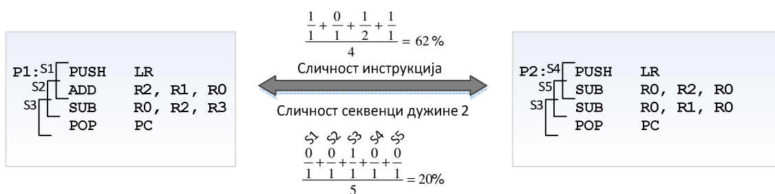
Слика 6.24 Пример примене технике бројања секвенци операционих кодова (трећа техника).
