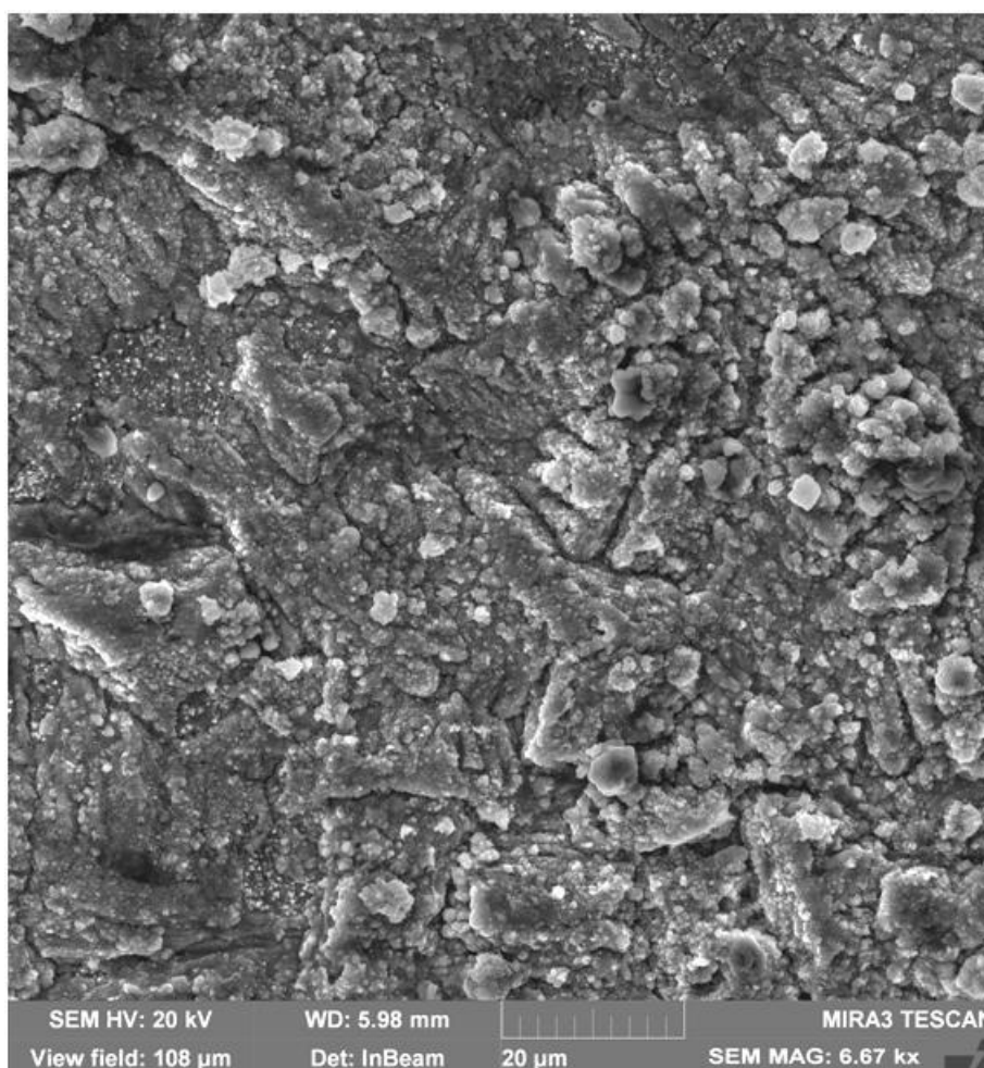
Slika 5.9.7. Površinski sloj na leguri VI (Cu72Zn28) pri povećanju 6670x
