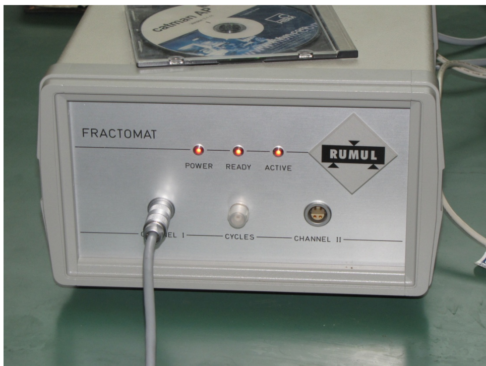
Сл. 8.4 Уређај FRAC TOMAT за регистрацију зависности \sigma - N
