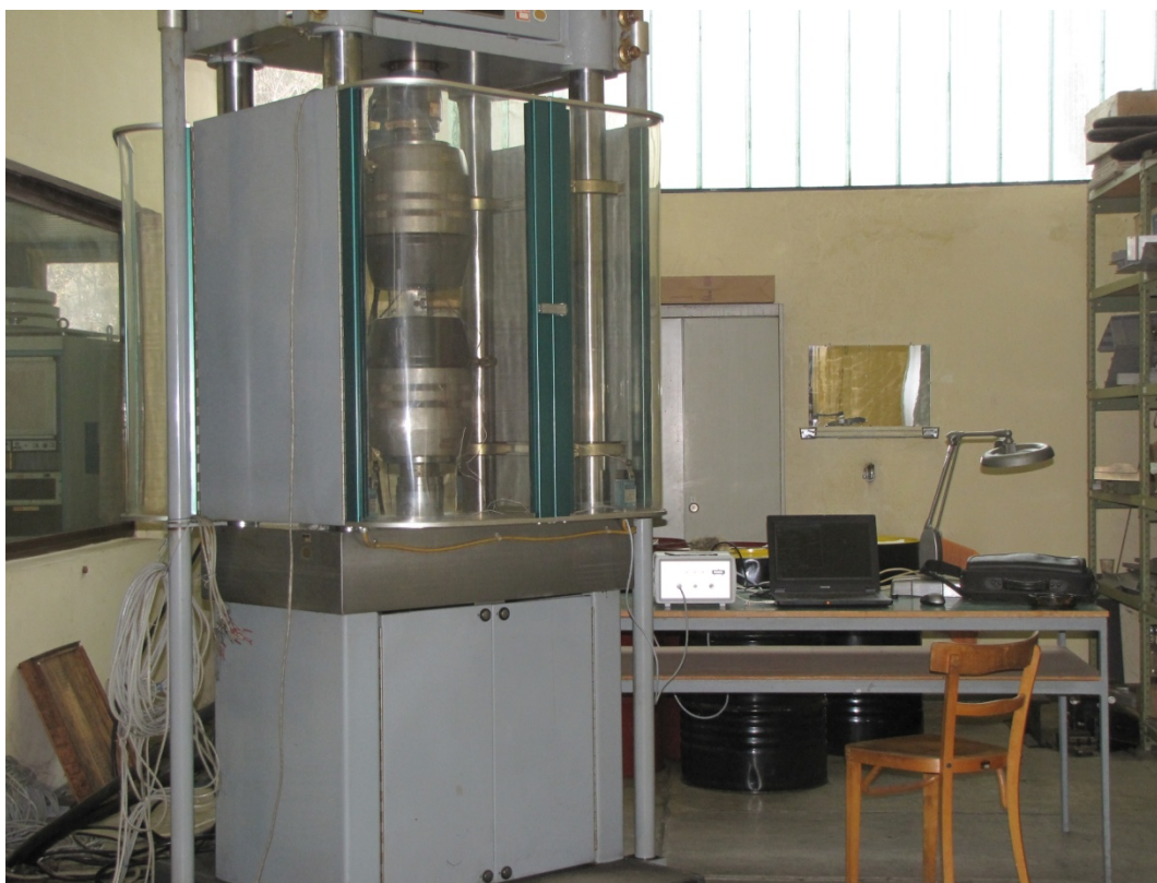
Сл. 8.3 Сервохидраулични систем МТС којим је уведено циклично оптерећење структуралног елемента
