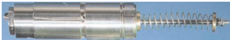
Slika 1.9 LVDT senzor pomeraja ili distance (Levin, 2002)
