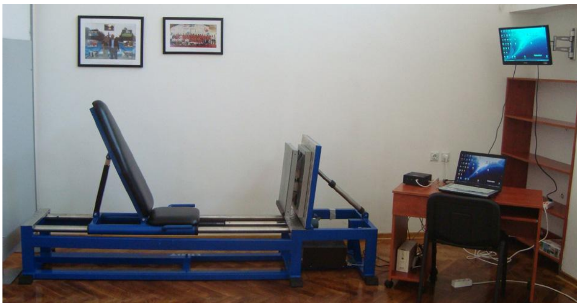
Slika 9. Aparatura za merenje maksimalne izometrijske mišićne sile opružaća nogu s pripadajućom hardversko-softverskom opremom
