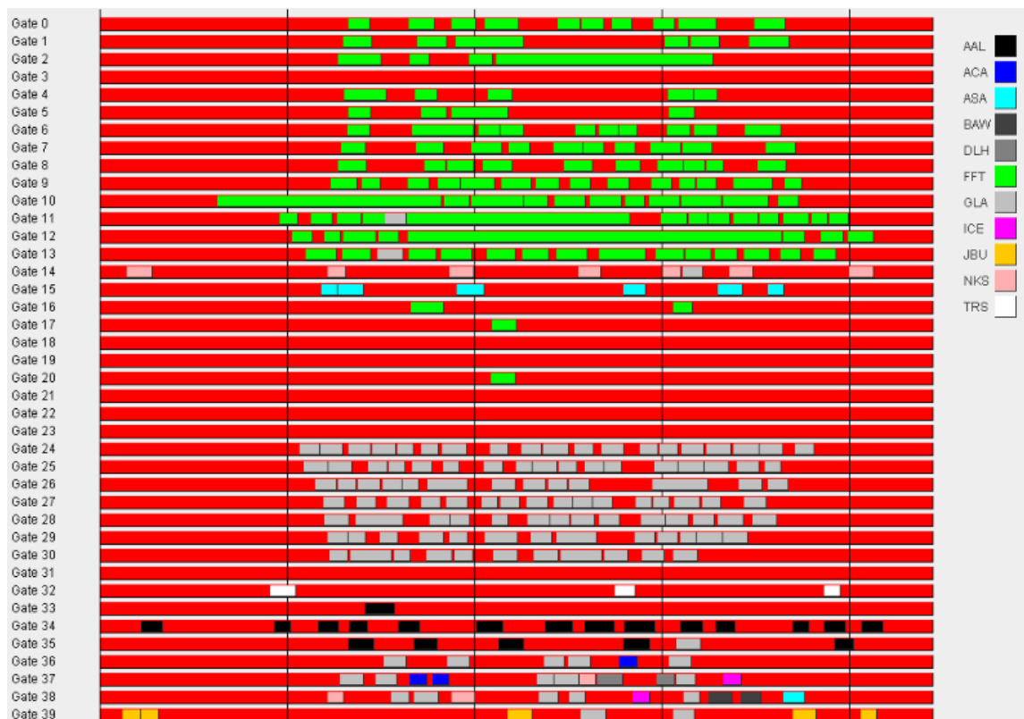
Слика 4.4. План додељивања паркинг позиција добијен лексикографском методом
