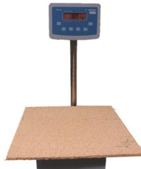
Slika V-23. Merenje mase gotove ploče
