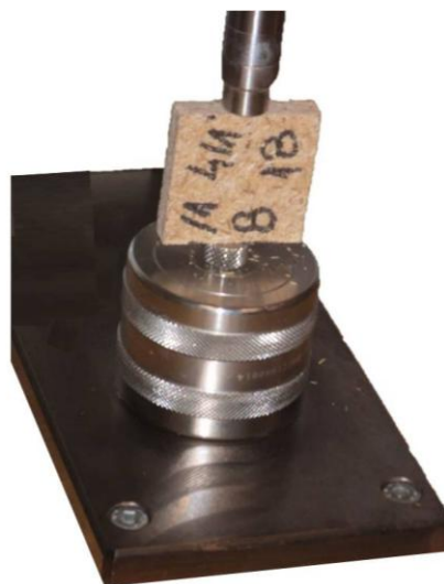
Slika 4.45. Merenje dimenzija ispitnih epruveta automatskim meračem dimenzija IMAL
