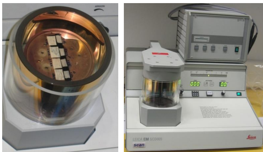
Slika 4.34. Uzorci drveta u komori za napanje uzoraka zlatom (Au) i ugljenikom (C): model LEICA SCD005
