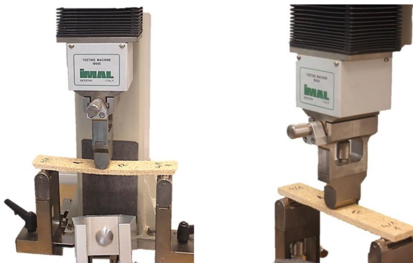
Slika 4.44. Određivanje savojne čvrstoće ploča
