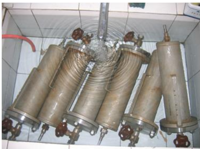
Slika 4.36. Hlađenje autoklava u vodenom kupatilu
