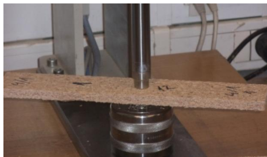
Slika 4.43. Merenje debljine uzorka automatskim meračem dimenzija IMAL
