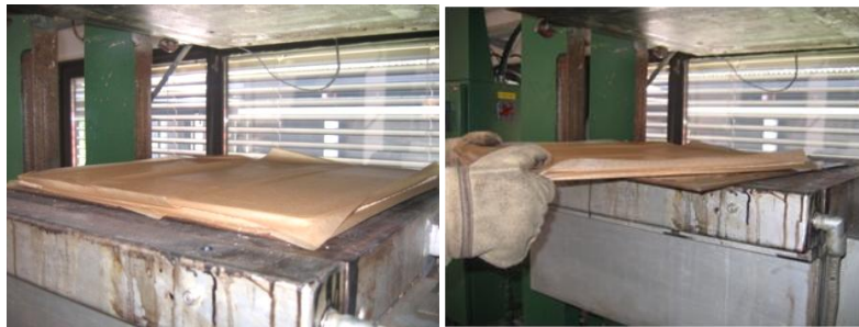
Slika V-21. Otvaranje prese i vađenje ploče iz prese
