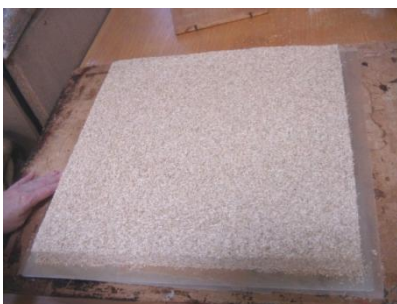
Slika V-15. Pripremljen tepih iverja
