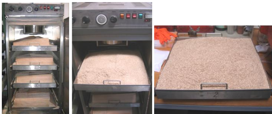
Slika V-1. Sušenje tretiranog iverja do sadržaja vlage 3%
