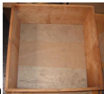
Slika V-11. Priprema kalupa: a) Podložna ploča; b) Kalup za formatiranje
