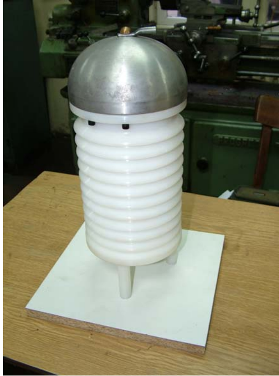
Fotografija 1. Izgled kapacitivnog naponskog razdelnika.
