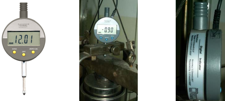
Slika 7.13. Merni sat – komparater Vogel tipa 242042, Germany
