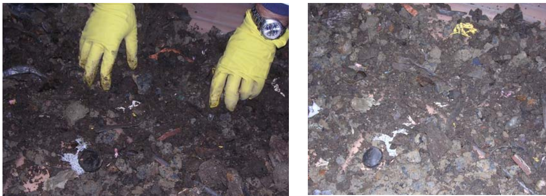
Slika 4.20 Postupak mešanja i pripreme materijala za sortiranje
