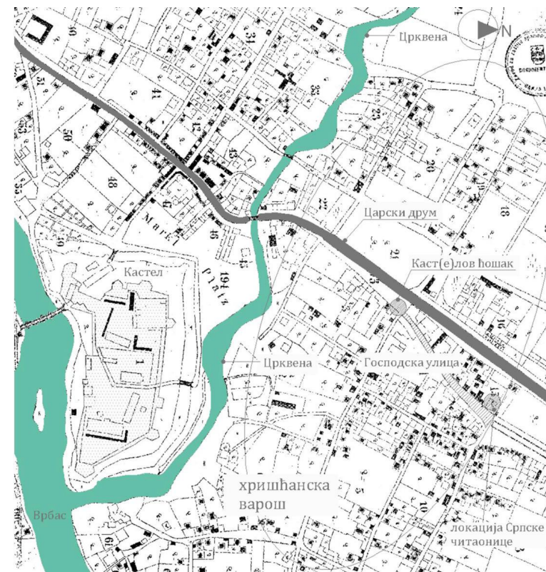
Слика 2.3. Фрагмент детаљне геодетске карте Бањалуке с почетка периода аустроугарске окупације, размјера 1:3125, на којој се види хришћанска варош на лијевој обали Црквене и Господска улица. Затамњени облици означавају дрвене грађевине и грађевине са каменим приземљем и дрвеном конструкцијом спрата, док су масивни зидани објекти необојени. Извор: картографска документација РЗКипН Републике Српске.
