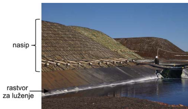
Slika 7. Bioluženje bakra u nasipima. (Slika je preuzeta i prerađena iz rada (Watling, 2008)).
