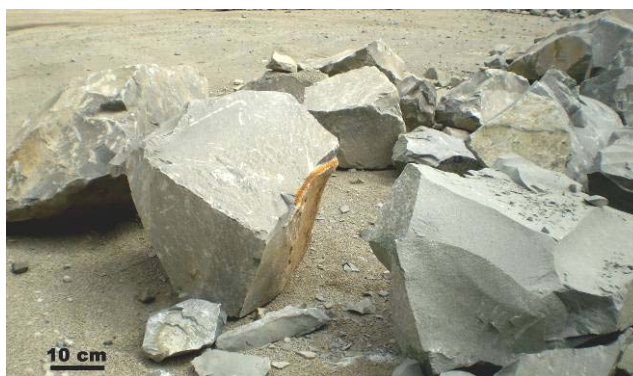
Slika 4.13-9: Nepravilni oblici prirodnih i miniranih blokova stenske mase.
