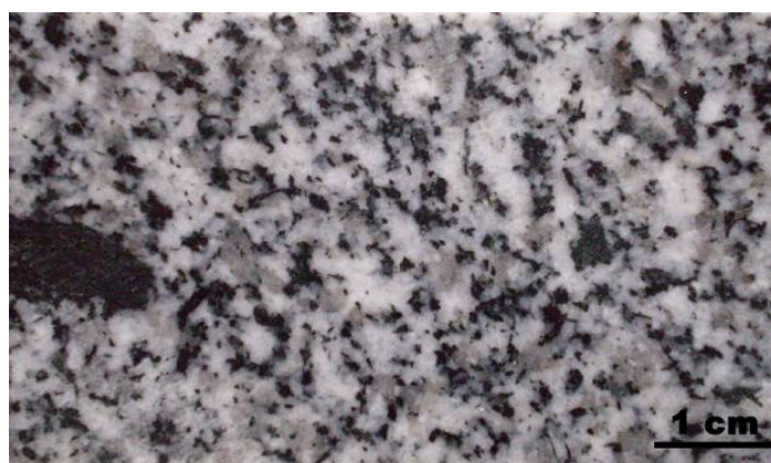
Slika 4.2-8: Izgled ravno sečenog uzorka granodiorita.
