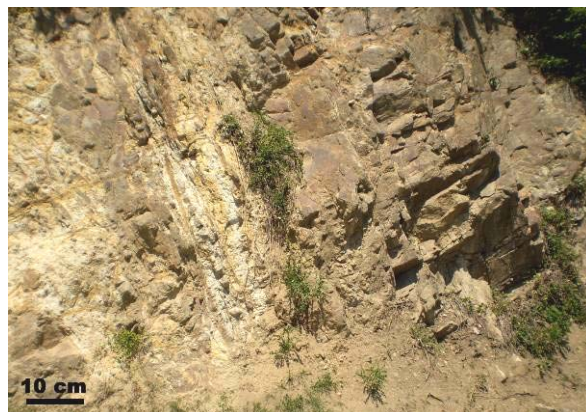
Slika 4.8-16: Pločasto lučena, ispucala i alterisana stena (Pajsijević – Kotlenik).
