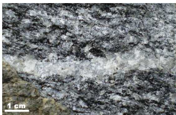
Slika 4.2-6: Planparalelna tekstura granodiorita.
