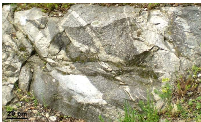
Slika 4.2-5: Nehomogen izgled stenske mase.
