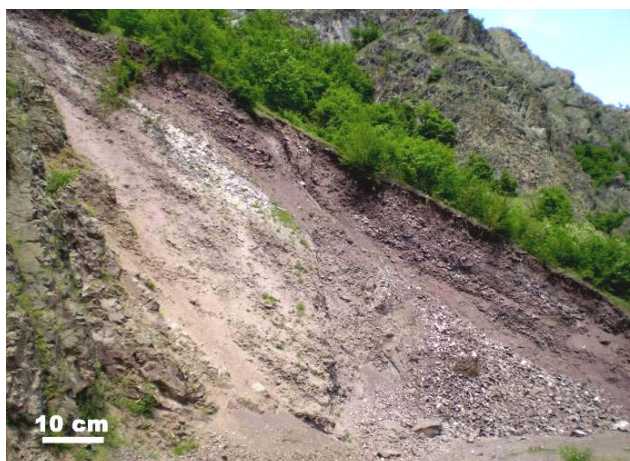
Slika 4.13-2: Alterisani, dezintegrisani vulkaniti (Raška).
