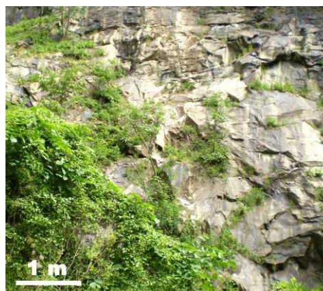
Slika 4.2-4: Nepravilno lučenje i ispucalost stene (Čokešina).
