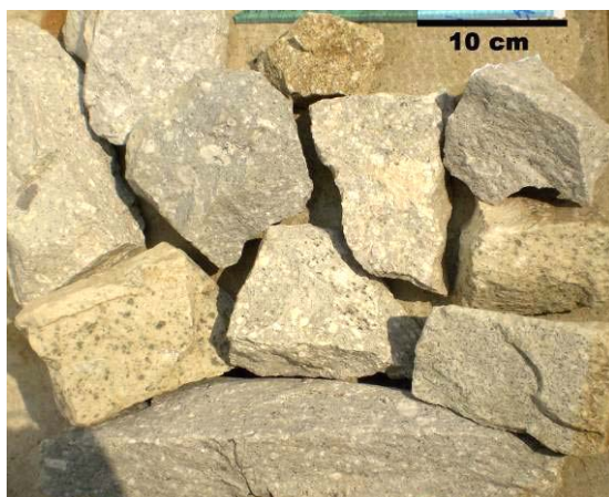
Slika 4.7-9: Variranje izgleda stene iz različitih delova stenske mase (Ćeramide).
