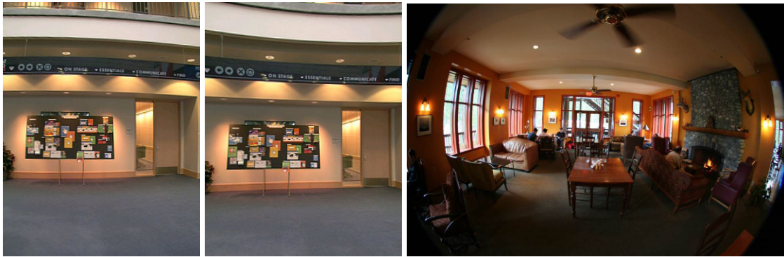
Слика 6.3 Примери радијалне дисторзије слике камере: а) конкавна, б) конвексна и в) у виду рибљег ока [178].
