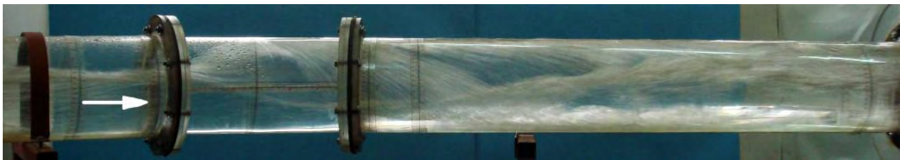
Слика 2. Хеликоидно течење низводно од кривине
