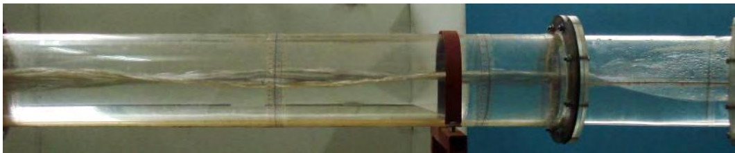
Слика 3а. Са повећањем брзине тока, повећава се увлачење ваздуха и таласна дужина стојећих таласа (растојање између два суседна максимума)
