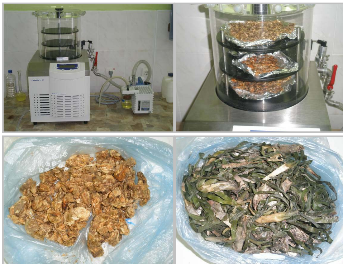
Slika 20. Liofilizator (Christ, Alpha 2-4 LD plus, Germany) i izgled liofilizovanih uzoraka (dole lijevo dagnja, dole desno morska cvetnica)
