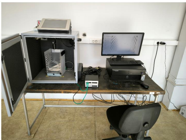
Slika 16. Sistem za uspostavljanje straha (levo) sa konzolom za kontrolu eksperimentalnih parametara (desno)
