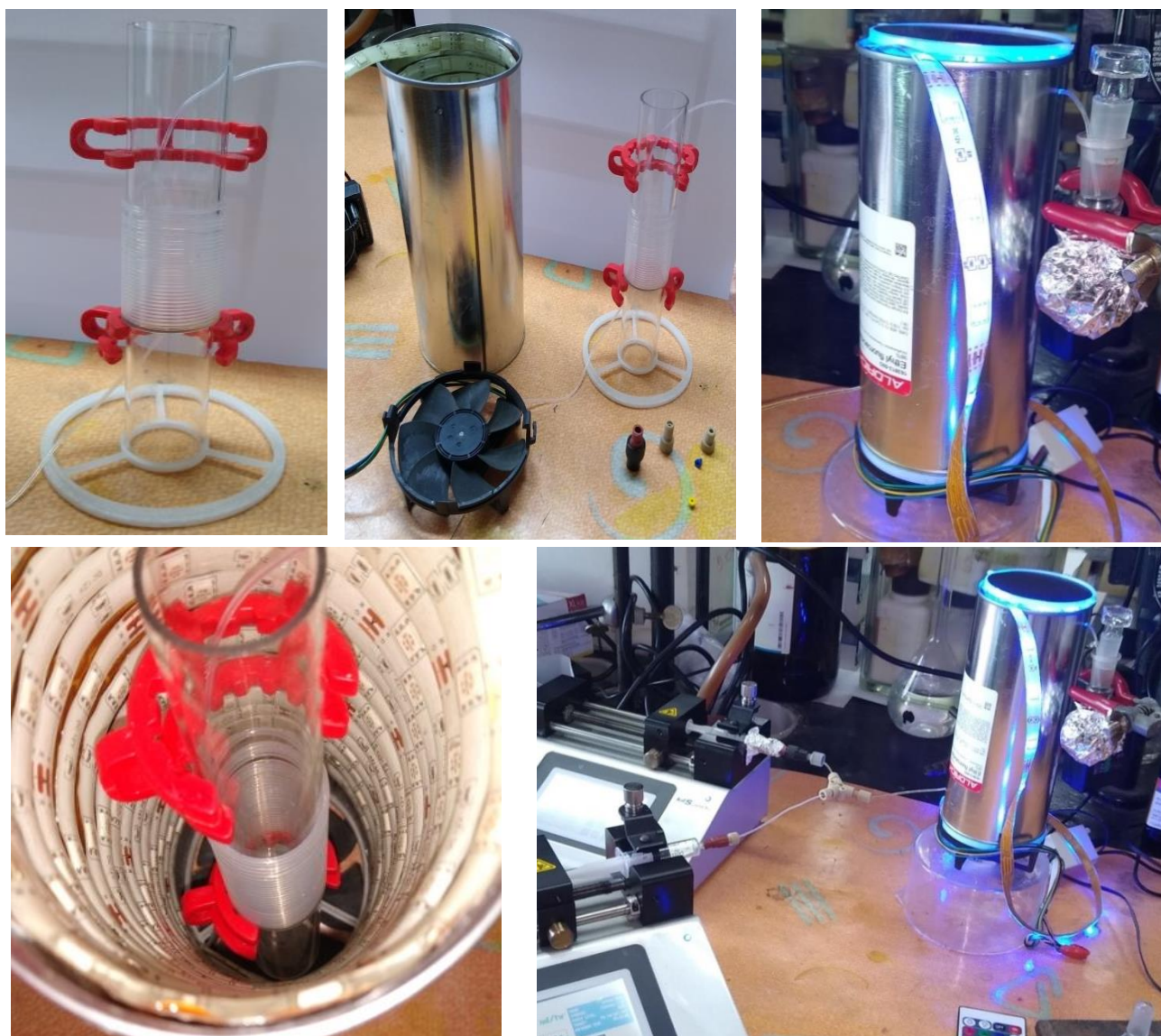
Слика 38. Изглед експерименталне поставке FEP микрофлуидног реактора када се као извор светлости користи LED трака, преузето уз дозволу из референце [250].
