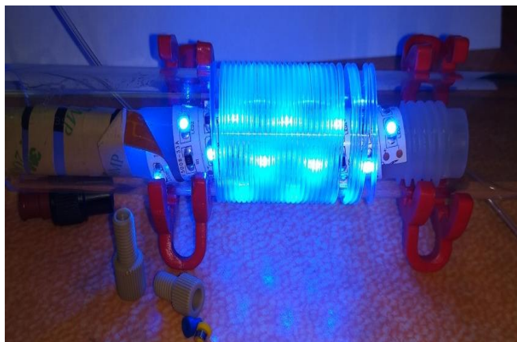
Слика 39. Фотореактор од FEP цева са LED траком као унутрашњим извором светлости.
