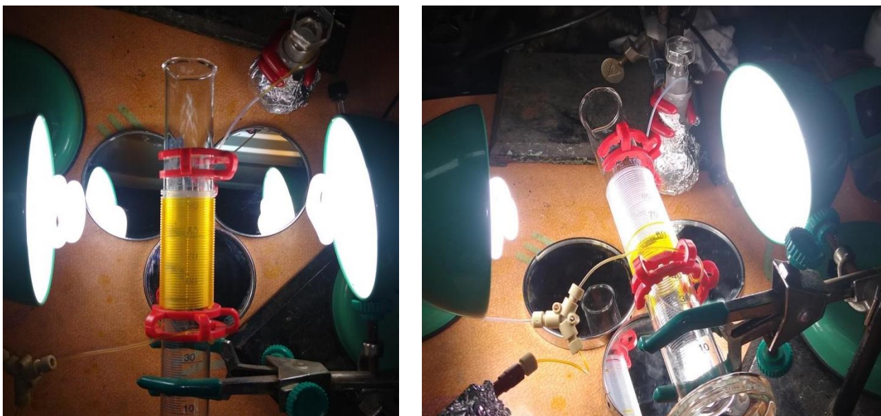
Слика 40. Фотореактор од FEP цева са CFL сијалицама као спољашњи извор светлости.
