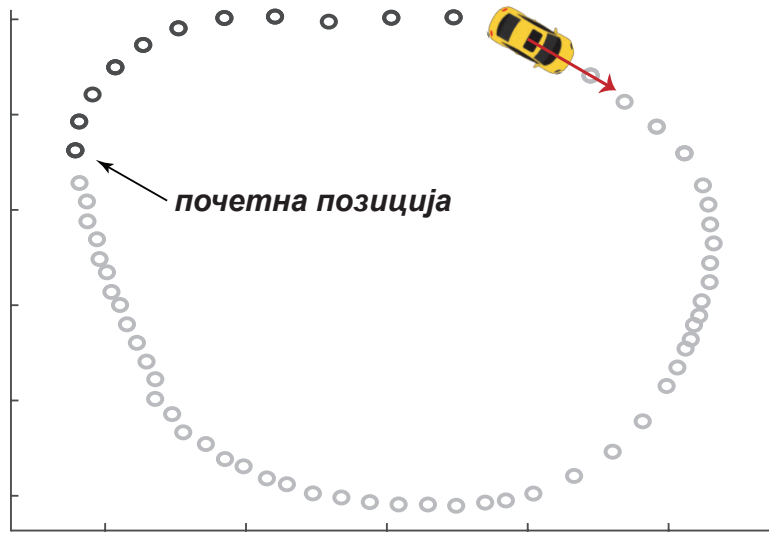
СЛИКА 4.5. Приказ сличности између реконструкције контура нерва и праћења циља (нпр. возила) у различитим временским корацима. Црне и сиве тачке представљају претходну и будућу путању, респективно. Обрађени подаци означавају позиције возила узорковане у једнаким временским интервалима. Већа густина тачака указује на већу брзину возила. Слика преузета из рада [144] и модификована уз дозволу.
