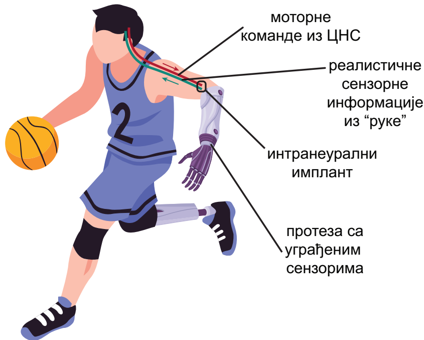
СЛИКА 1.1. Парадигма рада интерфејса: субјекат добија соматотопичне, тј. природне и интуитивне информације из околине уз помоћ интранеуралне електростимулације нерва у реалном времену, на основу читавања из сензора постављених у/на протезу.
