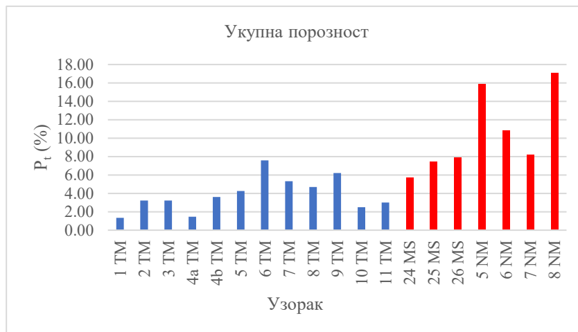
Слика 109. Графички приказ резултата мерења укупне порозности (плаво – узорци свеже стене, црвено-алтерисани узорци)
