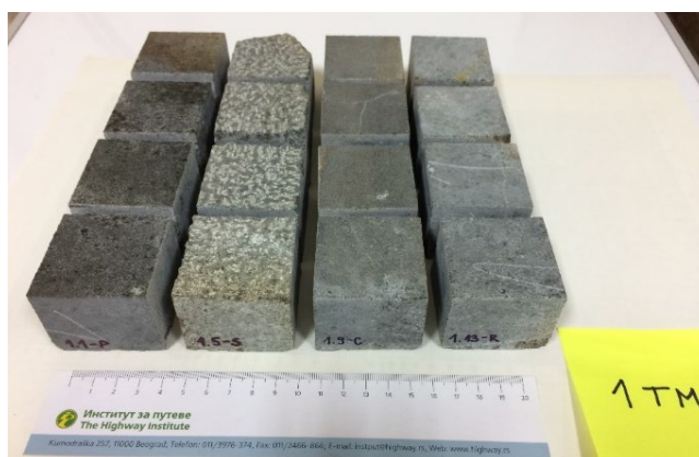
Слика 25. Изглед опитних тела за лабораторијска испитивања физичких својстава
