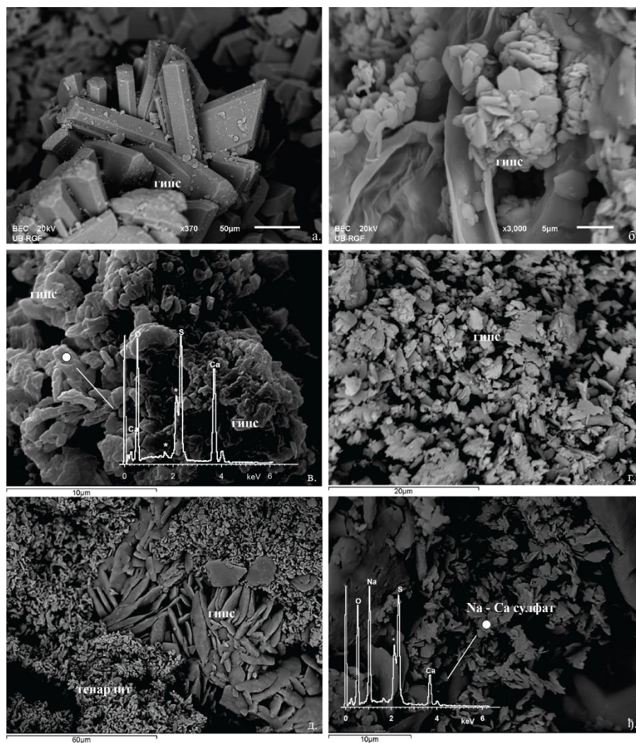
Слика 99. SEM снимци анализираних узорака соли: а) призматични кристали гипса у узорку соли са површине керсантиа из каменолома 3sTM; б) агрегат гипса у форми „пустињске руже“ са површине керсантиа у каменолому 1sTM; в) гипс у узорку 46MS; г) гипс у узорку 55MS; д) тенардит и гипс (узорак соли 64MS); е) Na – Ca сулфат у узорку 64MS
