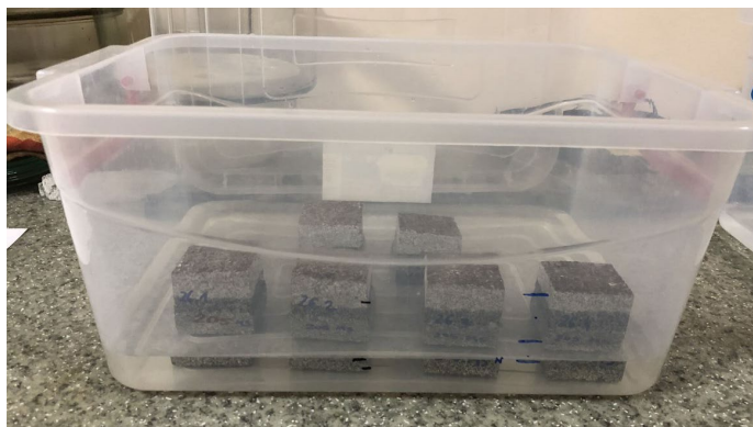
Слика 27. Испитивање упијања воде узорка керсантита
