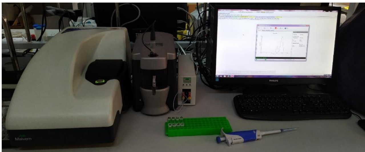
Slika 8.2.9. Uređaj za merenje naelektrisanja i veličine čestica Zetasizer (Malvern Instruments).
