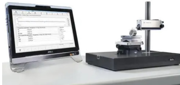
Слика 35: Апаратура за праћење храпавости узорка. (Слика преузета из [63])
