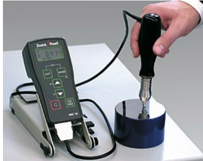
Слика 34: Апаратура за мерење тврдоће узорка. (Слика преузета из [62])
