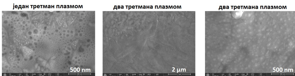
Слика 92: Узорак 16MnCr5 + TiN третиран плазмом у МПК, Регион 1 (SEM).
