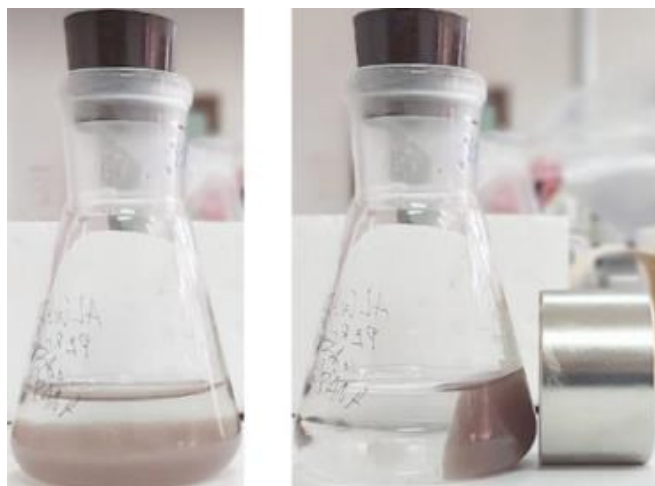
Slika 70. Odvajanje MAB čestica iz suspenzije spoljnim magnetnim poljem u roku od 1 min
