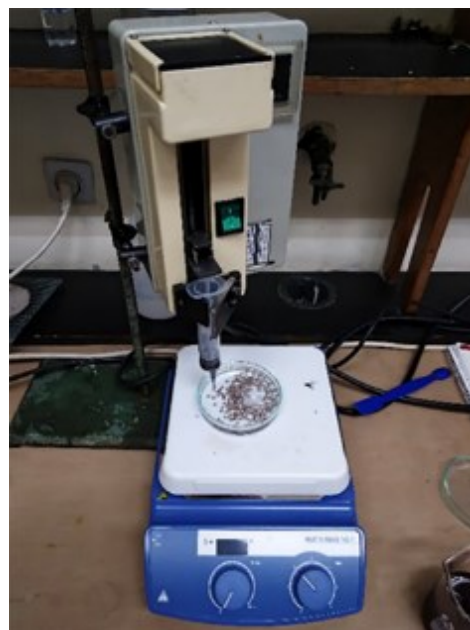
Šema 17. Šematski prikaz eksperimentalne aparature za dobijanje alginatnih mikročestica elektrostatičkom ekstruzijom (a): (1) 2% rastvor natrijum-alginata ( w/v ) (2) se propušta pumpom (3) kroz iglu prečnika 22 G, čiji je vrh odvojen 2,5 cm od površine rastvora za želiranje (1,5% rastvor \text{CaCl}_2 ( w/v )) (4) povezanu sa generatorom visokog napona, pri naponu od 6,5 kV (5) dobijene kapi se skupljaju u Petri šolji sa rastvorom za želiranje (1,5% rastvor \text{CaCl}_2 ( w/v )) (6) koji se meša na magnetnoj mešalici (130 rpm); (b) slika aparature za ekstruziju
