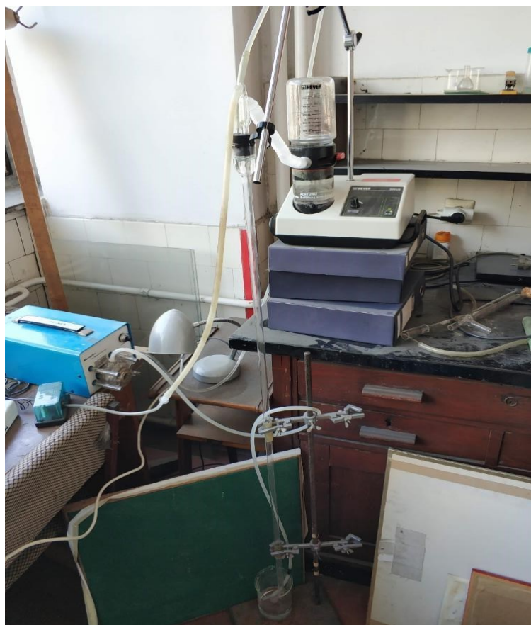
Slika 62. Aparatura za proizvodnju submikronskih alginatnih čestica metodom ultrazvučnog raspršivanja
